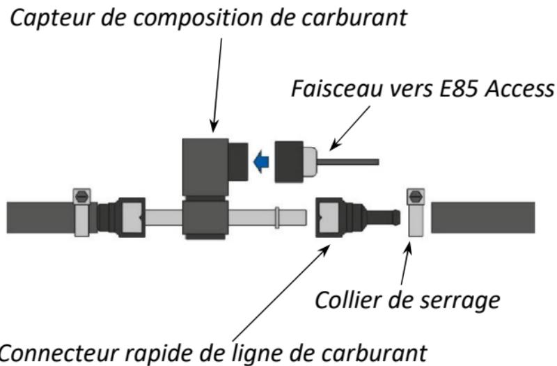
Lors de l'insertion dans la ligne de carburant, commencer par couper une durite de retour de carburant.
